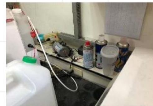
瓦斯罐獨立貯存遠離電源及發熱源
